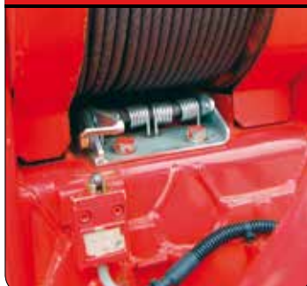
Snímač odmotání lana na bubnu
