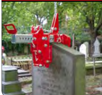
Robotické ocelové kleště (SWL:750kg)
