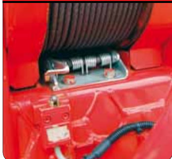
Snímač odmotání lana na bubnu
