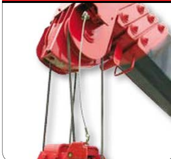
Snímač převrnutí háku
