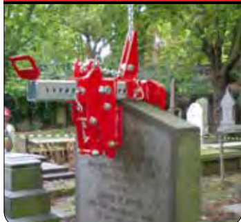
Robotické ocelové kleště (SWL:750kg)
